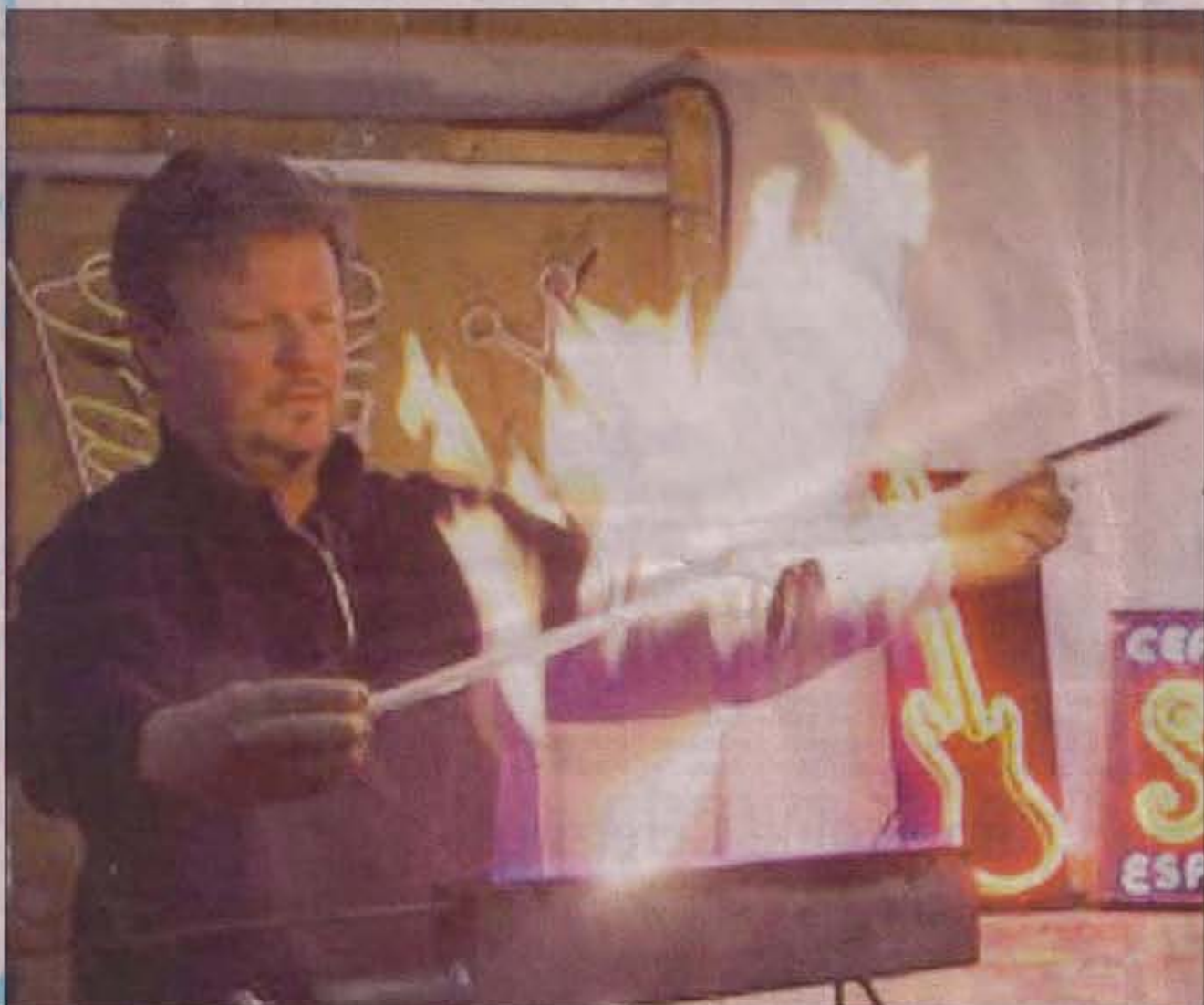
Der Neonkünstler Wolfgang M. Prose bei der Arbeit: Die Flamme, an der er seine Pyrex-Glasrohlinge in die gewünschte Form bläst, ist fast 450 Grad heiß. Fotos: Sewald
